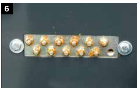
Lubrificação de corrente automática e pontos de engraxamento centralizados para os rolamentos dos rolos
